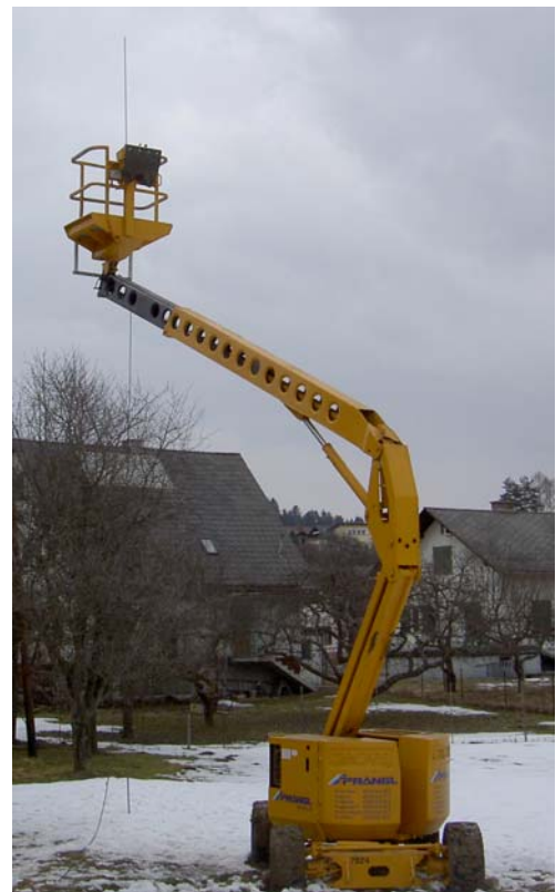
Abbildung 9: C-Netz Simulationssender auf mobilem Hubsteiger montiert, März 2006
