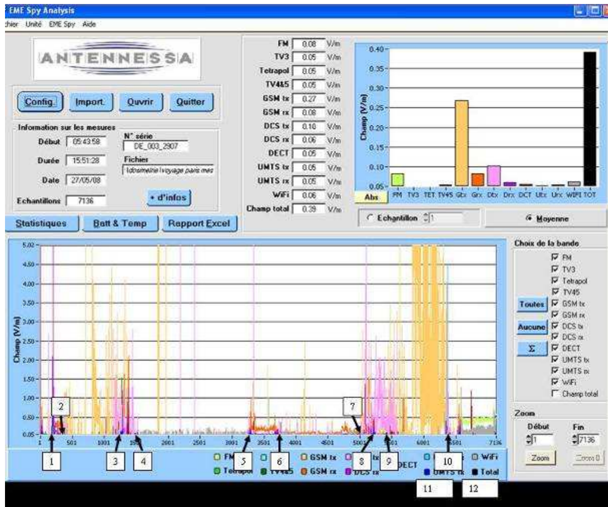
Figure 21 : enregistrement de l'exposition individuelle aux radiofréquences avec un exposimètre portable pendant 24 heures (source : université Lyon 1).
